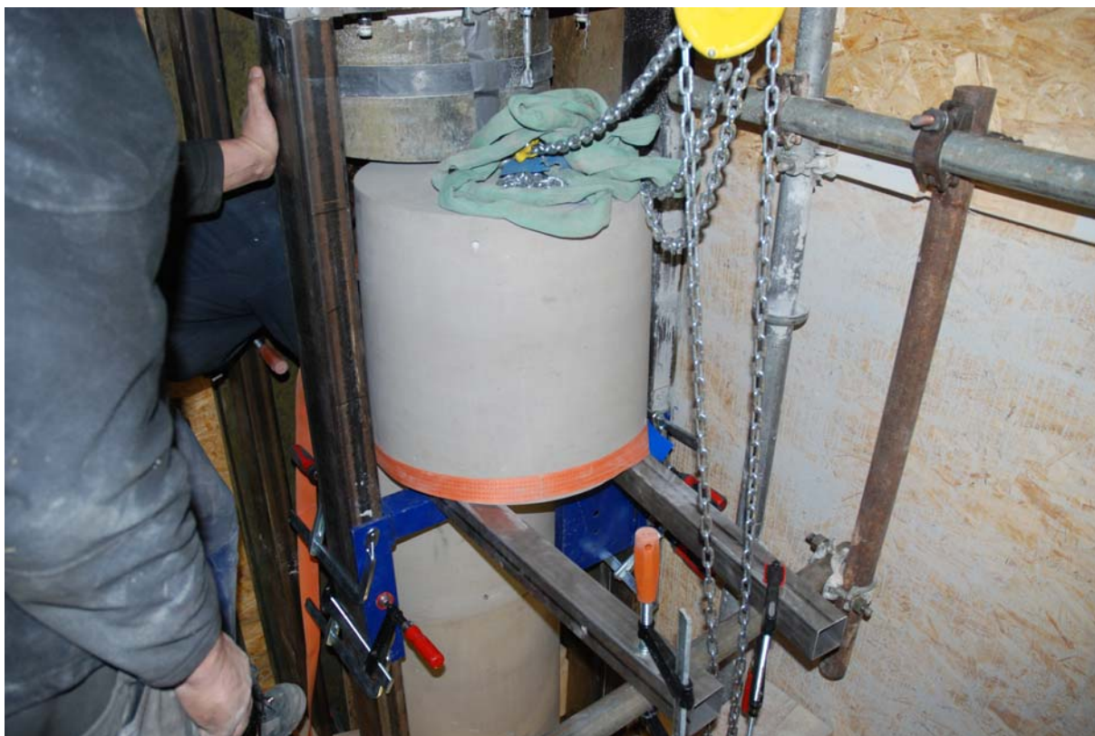
Övre trumman skjuts in på montetringskenorna.
