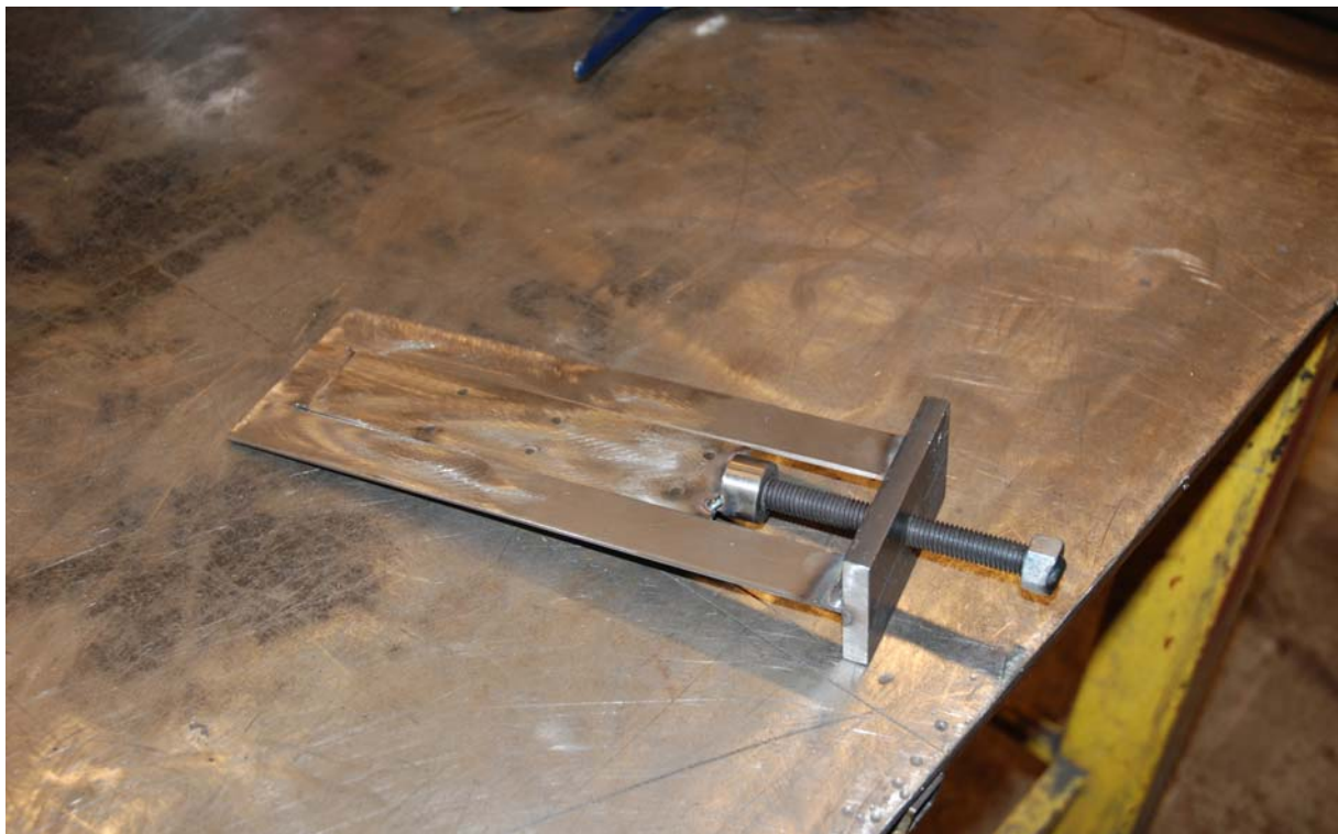
Specialverktyg för att lyfta övre trumman.
