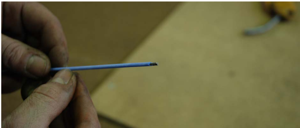
Lod Meltolit NS95. Ett nickellegerat brons-/mässingslod med hög hållfasthet och smältpunkt ca 900°C. Pinnen är belagd med flussmedel.
