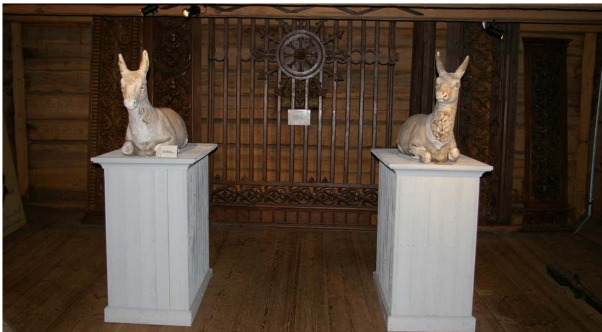
Modell av hjortar från Brevens Bruks museum. Modellerna användes för tillverkning av sandformen. Hornen göts separat. Foto Sirpa Ahonen, Brevens Bruk AB.
