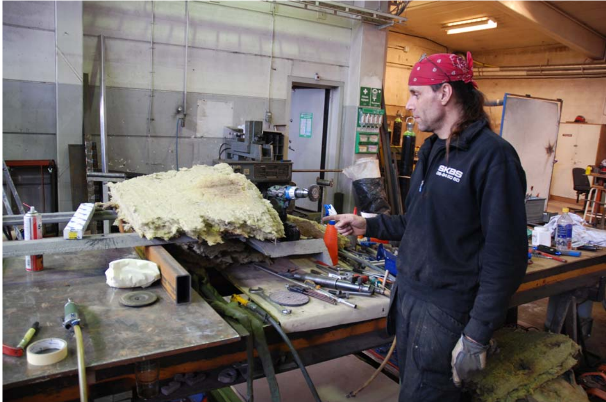
Lödning utfördes vid förhöjd temperatur på arbetsstycket. Stället sveptes efter lödning in i stenull för att svalna långsamt.
