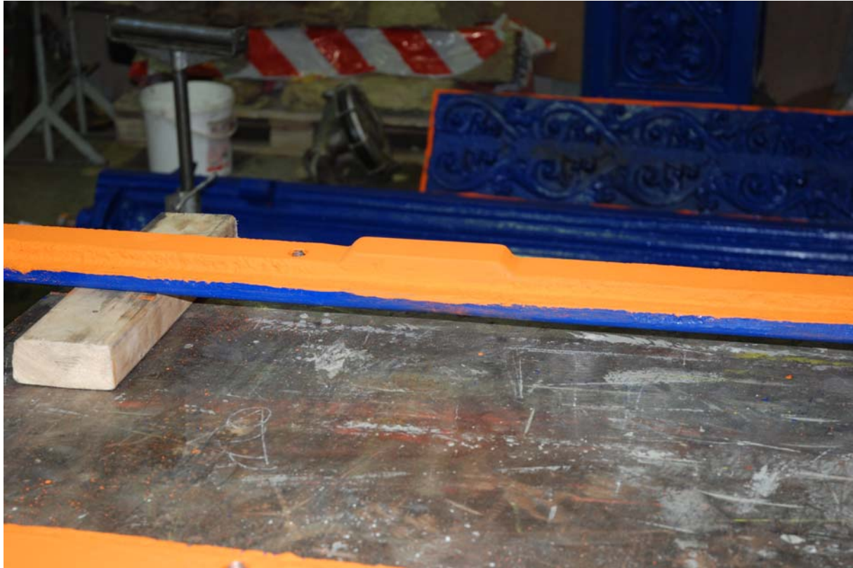
Lödstätte förstärkt med lask på insidan.
