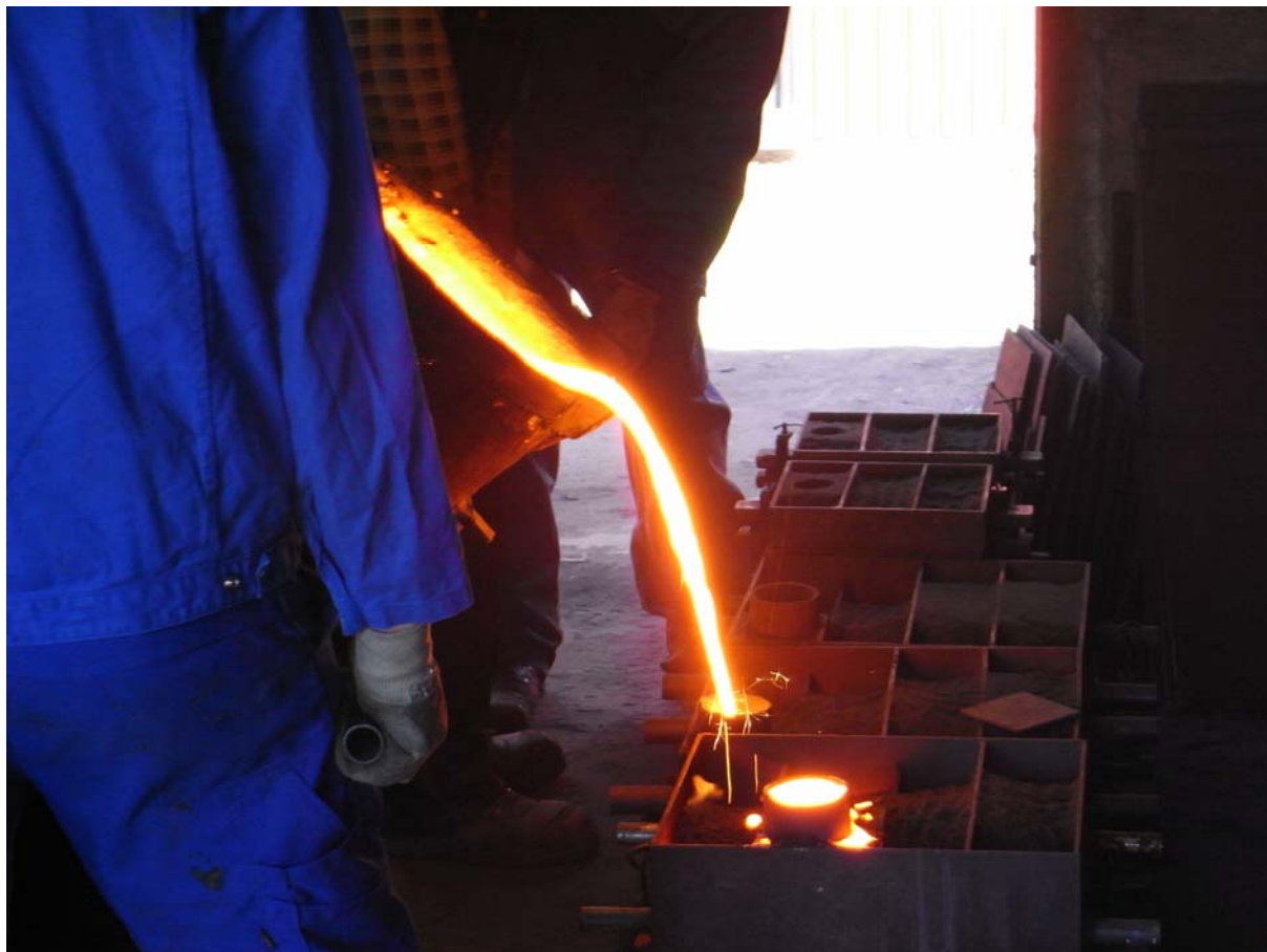
Gjutning av nya delar på Alunda Järngjuteri.
